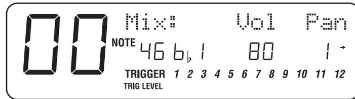
Wenn Sie Volume (Lautstärke) ändern möchten, dann bewegen Sie den Cursor mit den beiden [◀] und [▶] Tastern unter den Wert **Vol** und drehen am **[VALUE]** Regler. Der einstellbare Wert reicht von 00 bis 99.
